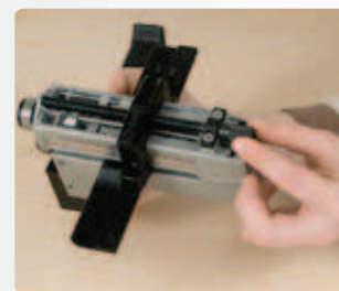
Réglage micrométrique de la largeur de coupe.
